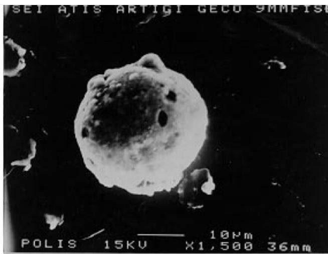
**Figura 10** – Imagem de elétrons secundários de um resíduo de arma de fogo [fonte: Turk J. Chem, 1999].
