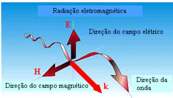
Figura 6 Onda eletromagnética genérica se propagando no espaço livre.
