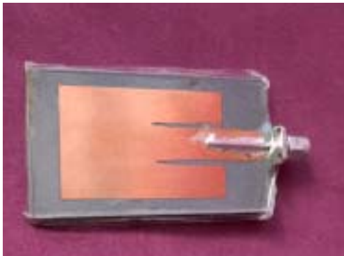
Figura 15. Antena em microstrip tipo "patch" retangular medida.
